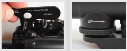
Ein Klick an der Rändelschraube entspricht  $\frac{1}{2}$  MOA. Nach der korrekten Einstellung der Höhe sollte diese durch die Sicherungsschraube wieder fixiert werden. Die Seitenkorrektur erfolgt direkt mit Hilfe des Multi-Tools an der entsprechenden Stellschraube.
