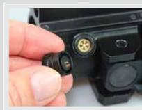
Um den Mini-Dongle zu verwenden, schrauben Sie den Schalter B1 ab und den Mini-Dongle auf das Gewinde.
